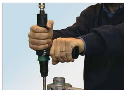
Les modèles 15C et 26C droites exigent de collier de serrage pour être monté sur des bras de support avec la poignée auxiliaire.
