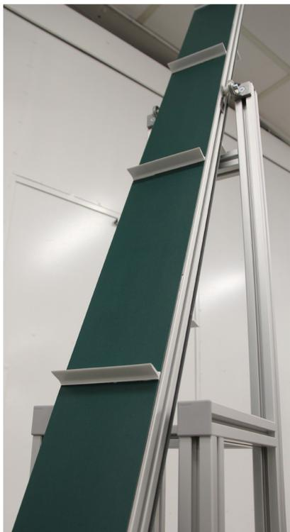
Tasseaux montés sur convoyeur élévateur
