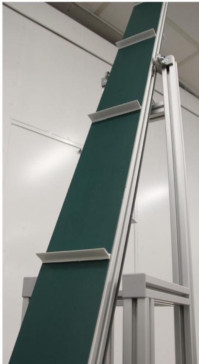
Tasseaux montés sur convoyeur élévateur
