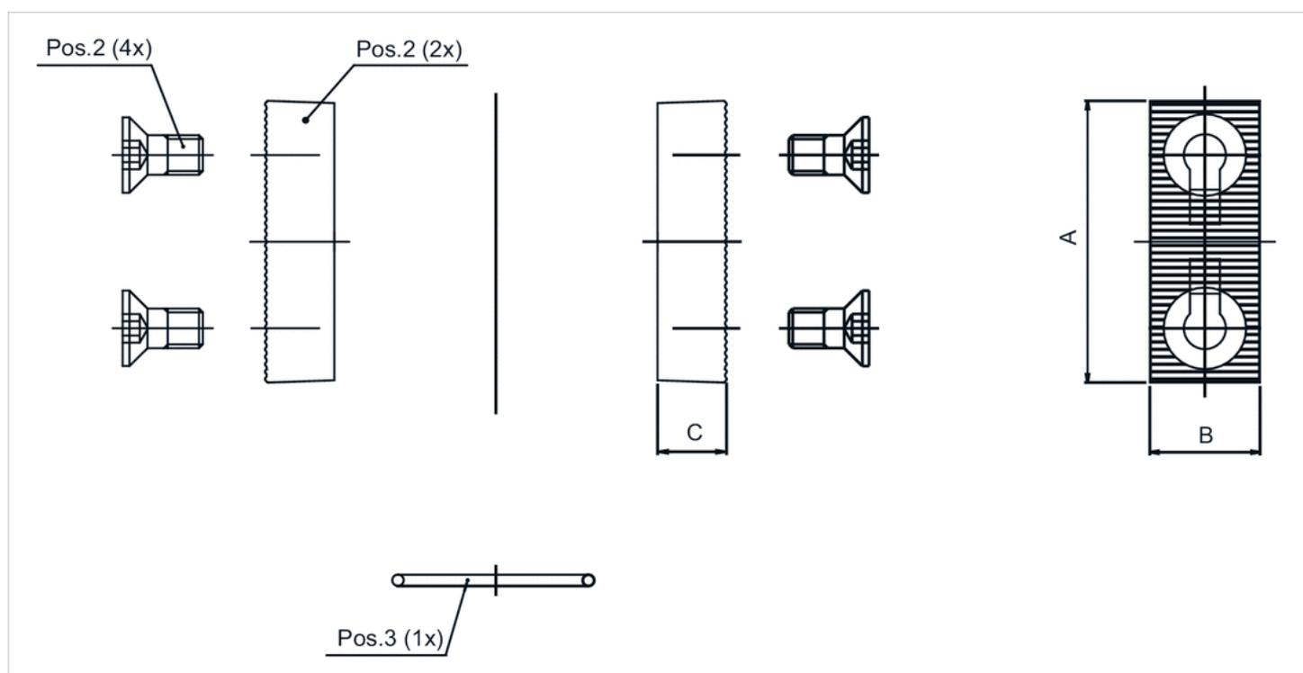
1) Support de fixation 2) Vis 3) Joint torique
