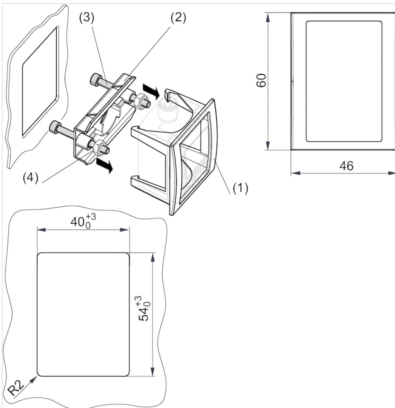
1 cadre (1), 1 fixation murale (2), 2 vis de fixation M4x40 (3), 2 écrous à six pans (4)
