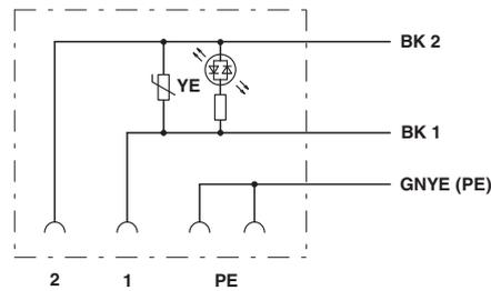
Disposition des contacts du connecteur pour électrovannes
