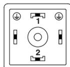
Schéma des pôles connecteur pour EV, type A
