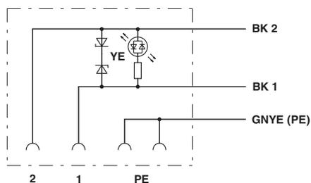
Disposition des contacts du connecteur pour électrovannes
