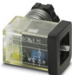
Connecteur pour électrovanne, 3 pôles, type C, 1 LED, avec circuit de protection, raccordement vissé, presse-étoupe M12
