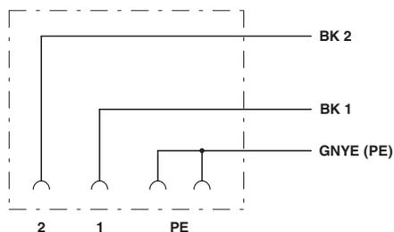
Disposition des contacts du connecteur pour électrovannes
