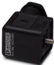
Connecteur pour électrovannes, 3 pôles, type B, non raccordé, raccordement vissé, presse-étoupe Pg9
