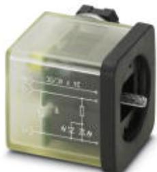
Connecteur pour électrovanne, 3 pôles, type A, 1 LED, avec circuit de protection, raccordement vissé, presse-étoupe M16
