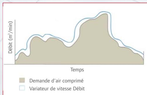
Un variateur de vitesse assure le contrôle du Nirvana. Le VSD du Nirvana 5.5/30 kW maintient avec précision une pression prédéterminée, règle automatiquement le débit d'air comprimé du système pour vous permettre d'obtenir le rendement le plus élevé pour vos opérations.
