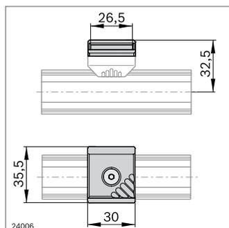
► Pour la fixation de bacs à l'aide de la fixation de bacs
