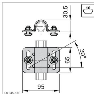
► Collier de serrage D28L, N10 pour la fixation de niveaux de matériaux avec rainure de 10 mm à un profilé rond D28L ; Le trou longitudinal permet d'incliner le niveau de matériaux jusqu'à 30 degrés
