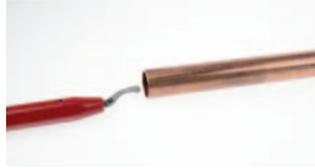
Ébavurer les bords intérieurs et extérieurs (tube métal) ; lorsqu'un cintrage du tube est nécessaire, le réaliser avant le raccordement.
