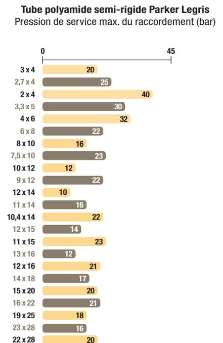
Pour un montage avec un écrou 0110 suffixe 70, la pression maximale est de 10 bar, pour tous les diamètres.
