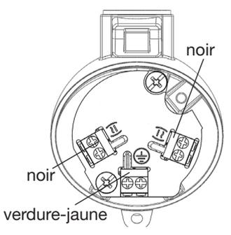
Fig. 5 : Coffret à bornes
