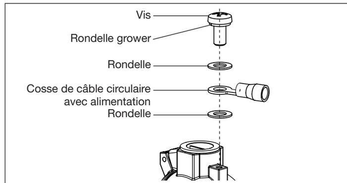
Fig. 6 : Raccordement de la compensation de potentiel externe
