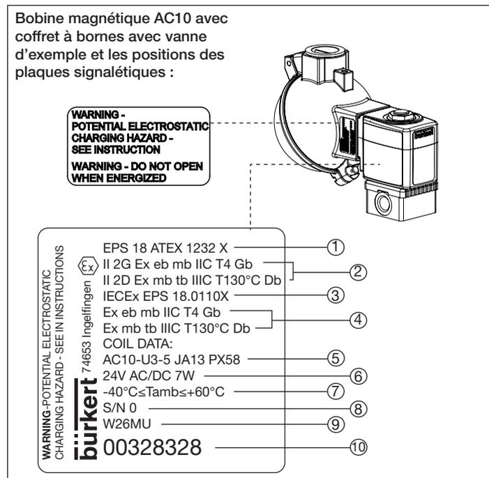
Fig. 4 : Emplacement et description des plaques signalétiques Ex
