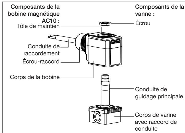
Fig. 1 : Bobine magnétique type AC10 avec départ de câble
