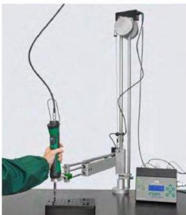
Bras Cartésien avec dispositif de détection de la position
