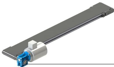
Notre convoyeur à bande type 30 est un convoyeur à bande lisse compact grâce à son châssis en profilés aluminium de 30 mm d'épaisseur. Conçu pour s'intégrer parfaitement dans une machine ou une structure en profilés aluminium, ce convoyeur est idéal pour le transport de petites pièces avec une charge moyenne maximale de 20 kg (sans accumulation).
