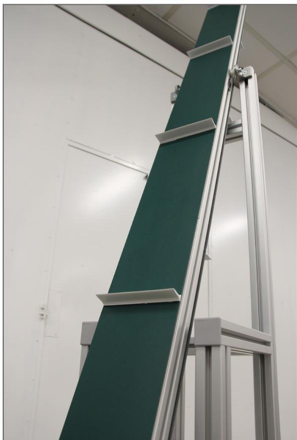
*Tasseaux montés sur convoyeur élévateur*
