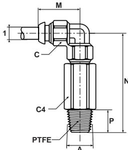
Livré pré-enduit de produit d'étanchéité PTFE.
