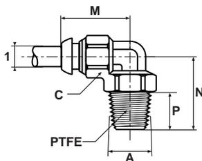
Livré pré-enduit de produit d'étanchéité PTFE.
