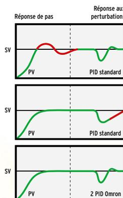
La régulation à double PID Omron permet une avancée importante sur la régulation PID standard. Le contrôle à double PID utilise un algorithme puissant qui permet à l'instrument d'être réglé pour une réponse optimale aux perturbations quelle que soit la vitesse de réaction aux modifications du point de consigne. Le principal avantage est que l'utilisateur ne doit
