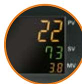
Les séries E5EN et E5AN permettent d'activer une 3ème ligne d'affichage. Sur cette ligne, vous pouvez afficher la sortie (MV), le temps d'exposition restant ou d'autres paramètres de fonctionnement.
