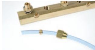
Glisser l'écrou sur le tube ; lubrifier le filetage du corps, la bague et le taraudage de l'écrou pour faciliter le serrage (idem pour la version inox) ; monter la bague sur l'extrémité du tube.
