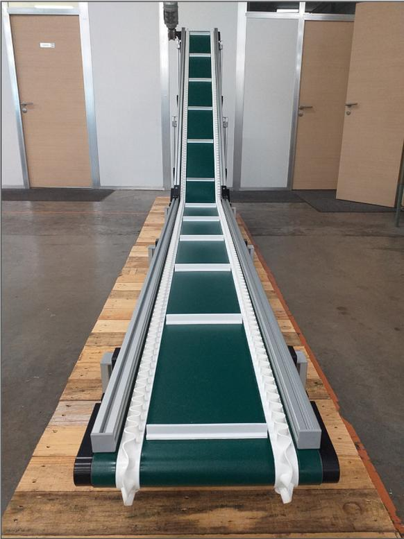
Tasseaux montés sur convoyeur articulé
