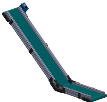
Variante de notre convoyeur type 40 extrémité, cette version « Articulée » permet d'acheminer des pièces de petites tailles, ou en vrac, en élévation. Sa partie horizontale est destinée à la dépose des pièces et sa partie inclinée, sans interruption de la bande, transporte les pièces vers un niveau supérieur. La bande est généralement équipée de tasseaux (et de bords de contenance si besoin) pour assurer l'élévation des pièces. La position des tasseaux est adaptable selon le besoin.
