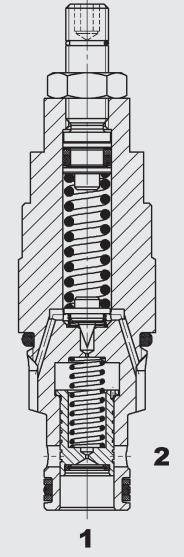
Le DB10P est un limiteur de pression à pilotage direct en exécution tiroir. Lorsque la pression à l'orifice 1 augmente et excède la valeur de consigne, l'étage pilote s'ouvre et l'huile circule de l'arrière du piston principal vers le raccord 2 du réservoir. La différence de pression qui en découle provoque le déplacement du piston principal contre le ressort de rappel et permet à l'huile de circuler de l'orifice 1 vers l'orifice 2.
