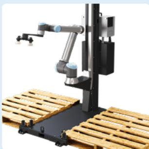
La facilité d'utilisation est redéfinie grâce à la solution de palettisation Robotiq pour une hauteur maximum de palettes de 2750 mm. Vous n'avez qu'à ouvrir le carton, le matériel et le logiciel sont déjà connectés et prêts à être installés.
