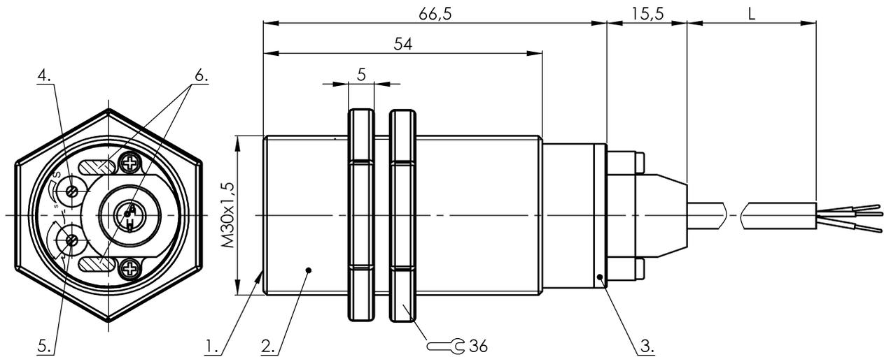
1) Face sensible, 2) Boîtier, 3) Couvercle, 4) Potentiomètre, 5) NO ou NF sélectionnable, 6) LED de visualisation d'état
