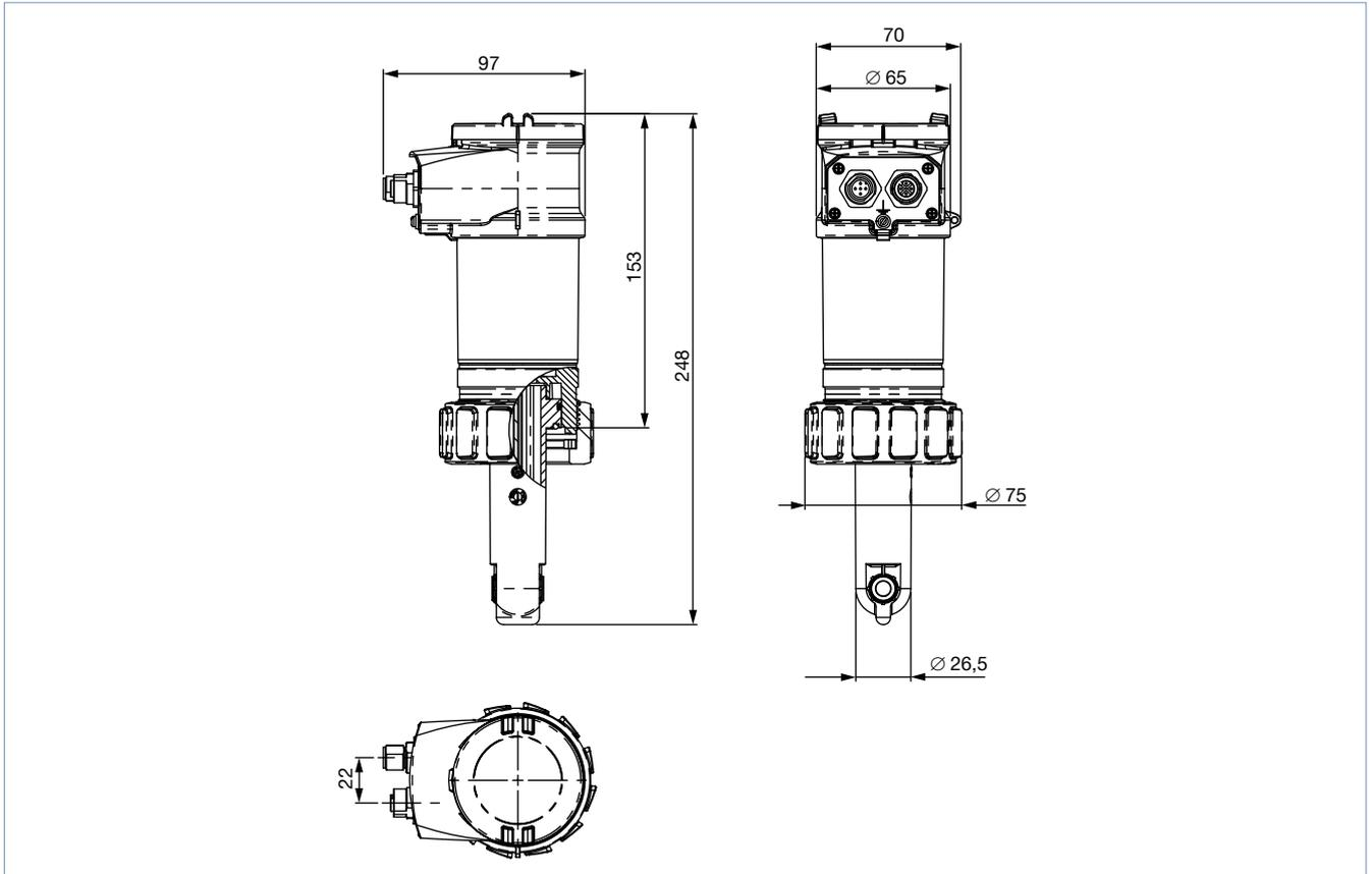
Avec raccordement au process G 2", montée dans un raccord Insertion Type S020
