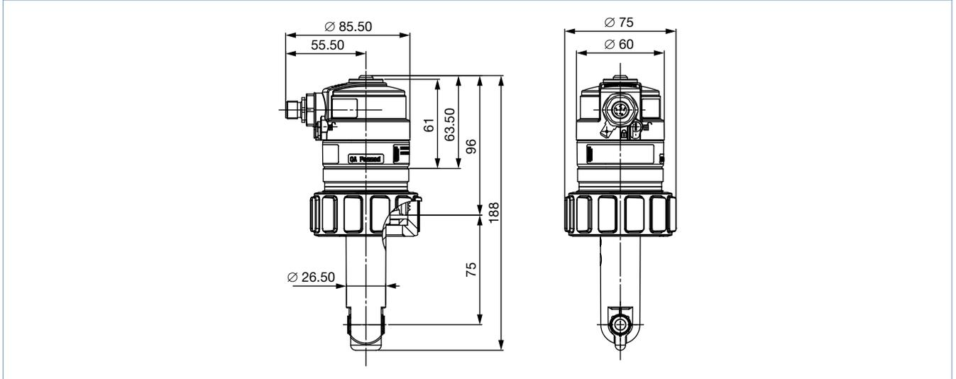
Avec raccordement au process G 2", montée dans un raccord Insertion Type S020
