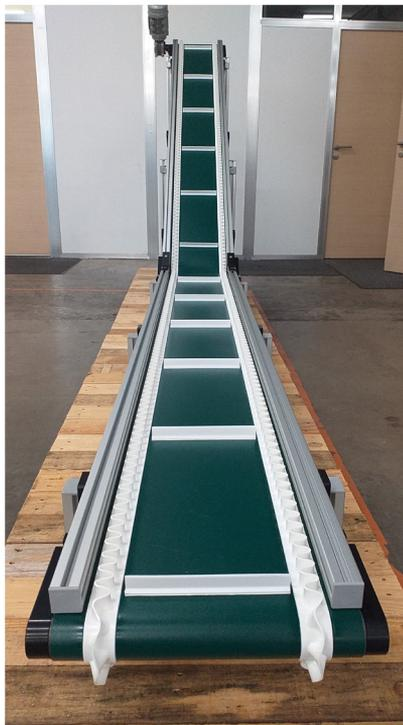
Tasseaux montés sur convoyeur articulé
